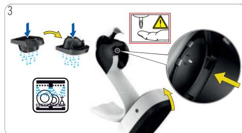
3 Limpe com detergente líquido e água potável fresca ambos os lados do suporte de cápsulas. Alternativamente pode ser lavado na lava-louças. Seque em seguida. Limpe a cabeça da máquina em torno do injetor com um pano macio e úmido.
