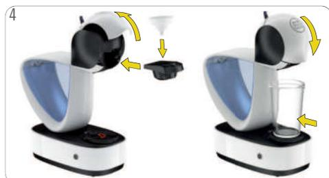
4 Abra a alavanca de fechamento. Coloque a ferramenta de enxágue no suporte para a cápsula. Insira o suporte de cápsulas na máquina. Feche a alavanca de fechamento. Coloque um recipiente grande vazio embaixo da saída da bebida.
