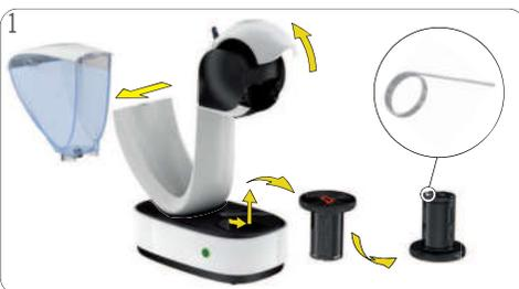
1 Assegure-se que o suporte de gotejamento esteja vazio. Remova o reservatório de água. Abra a alavanca de fechamento. Remova e incline a gaveta de recolha de pingos. Retire a agulha para limpeza. **Mantenha a agulha fora do alcance das crianças!**
