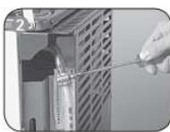
3. Coloque a outra braçadeira na extremidade oposta da mangueira. Encaixe a mangueira no regulador de pressão e aperte-a com o auxílio de uma chave de fenda.
