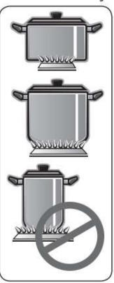
Para reduzir o consumo e para obter o melhor aproveitamento do gás, é recomendável o uso de panelas com diâmetro adaptado ao tamanho dos queimadores, evitando, assim, que a chama se espalhe pelas laterais das panelas.
