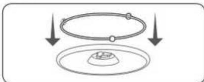
4. Encaixe o suporte do prato giratório na cavidade, no centro do forno. As roldanas são iguais, na parte superior e inferior do suporte, portanto sua posição é indiferente.
