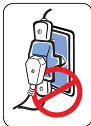
Ligue seu Bebedouro a uma tomada exclusiva. Não utilize extensões ou conectores tipo T (benjamim). Este tipo de ligação pode causar acidentes com fogo e uma sobrecarga na rede elétrica prejudicando o desempenho do seu aparelho.
