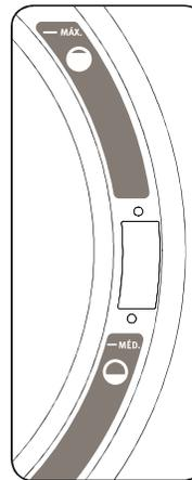
Coloque as roupas na secadora de acordo com a indicação de nível existente na própria secadora. Não ultrapasse o nível máximo, pois a secadora precisa de espaço para fazer com que as roupas sequem por igual. Ao sobrecarregar a secadora você não obterá bons resultados de secagem.
