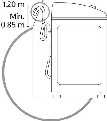
Nunca solte a mangueira de saída de água da abraçadeira fixada no gabinete, pois além de evitar cortes na mangueira, a abraçadeira garante a altura necessária para o funcionamento correto da Lavadora. Caso o comprimento da mangueira não seja suficiente para atingir o ponto de escoamento, procure a **Rede de Serviços Consul** - para a compra de uma mangueira disponível com 2,30 m de comprimento.
