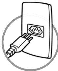
3. Verifique se a tensão de alimentação indicada na etiqueta do cabo de força da Lavadora é a mesma da tomada onde ela será ligada (127 ou 220 V).
