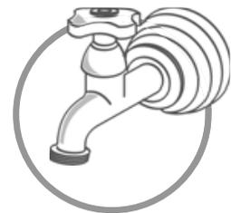
A pressão de água para abastecimento deve corresponder a um nível de 20 a 800 kPa (aproximadamente 2 à 80 m de coluna de água acima do nível da torneira)
